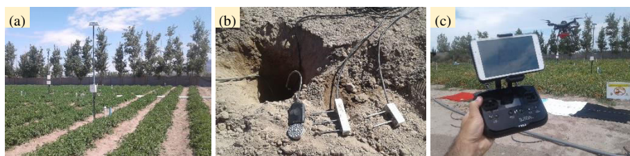
Fig. 21. Implementación del sistema de Telemetría Agrícola para gestionar tres tratamientos de riego en una parcela de tomates. (a) Parcela experimental de tomate (900m2). (b) Sensores instalados en las estaciones de medición. (c) Uso de cuatrirrotor para adquisición de imágenes multiespectrales y termográficas sobre el ensayo.
