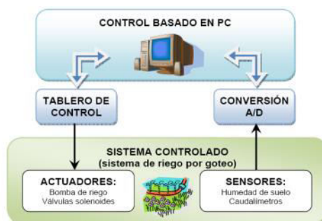
Fig. 6. Sistema de monitorización y control automático de riego basado en PC.
