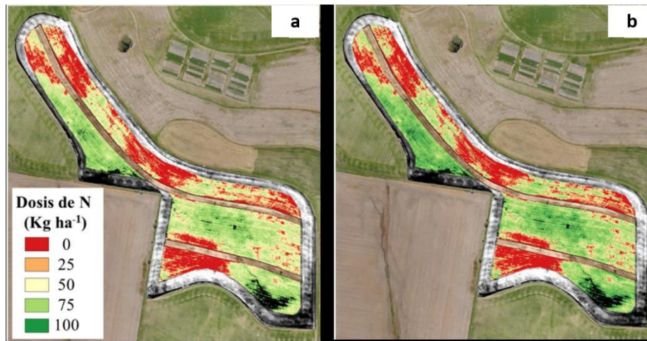
Fig. 4. Mapas de prescripción para dosis de refertilización de nitrógeno en el cultivo de trigo estimados utilizando índices de vegetación calculados desde imágenes obtenidas con un dron y estimaciones de la respuesta en base a referencias virtuales calculadas como a) el percentil 90 del NDVI y b) el percentil 95 del NDVI. Adaptado de [33].
