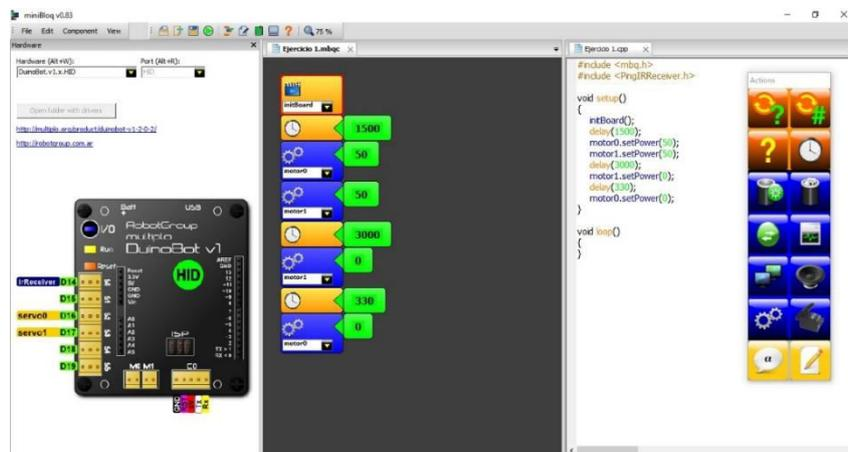
Fig. 5. Código en Minibloq para encendido de motores y retraso de una rueda.
